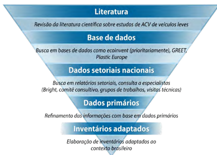
→| Figura 4.4 – Processo de criação e adaptação de inventários do ciclo de vida
